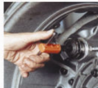
▲ Dispozitiv IUS INTERIOR este disponibil in 6 dimensiuni asigurand reparatia filetelor interioare cu diametre cuprinse intre 8 mm ( 5/16 ) si 68 mm ( 2\frac{7}{8} ).
